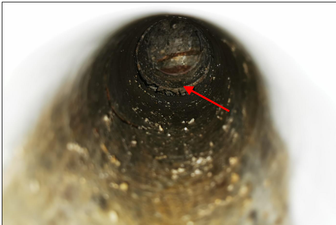
Foto 21: Pohled do vývrtu V5, ve vývrtu spára kolmá na líc klenby (červená šipka)
