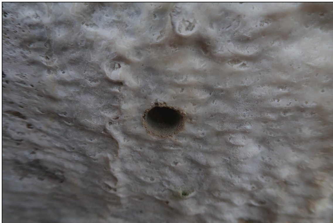
Foto 13: Detail místa odběru vzorku solí VZ1, výrazné výluhy pravděpodobně kalcitu
