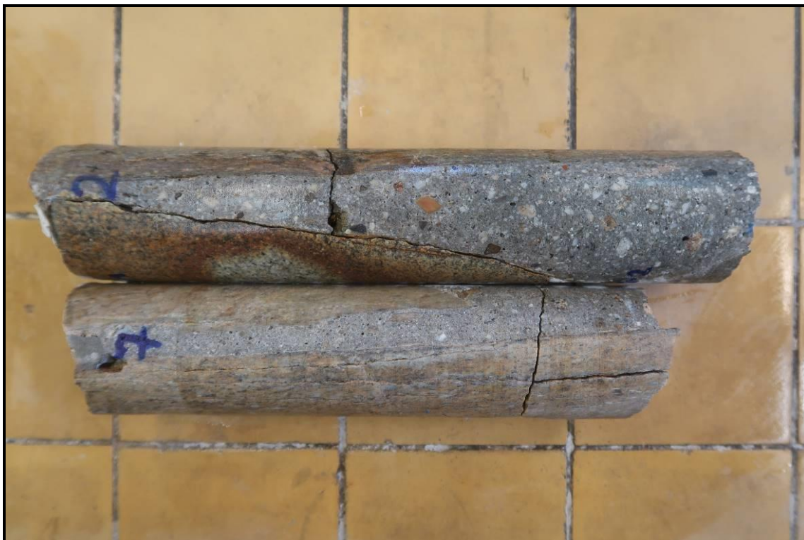
Foto 3: Pohled na vrtná jádra (V2 a V7) Ø 80 mm odebraná z ložných spár, ložné spáry v obou případech plně vyplněné maltou/betonem
