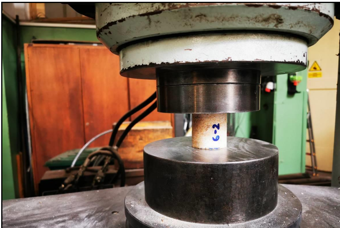
Foto 11: Zkušební těleso 6-2 v zatěžovacím lisu
