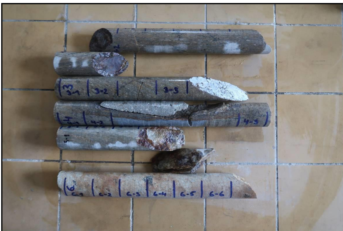
Foto 2: Pohled na vrtná jádra z fotografie 1, rozdělení vzorky na dílčí lomové plochy, např. vývrt 3, zlom pokryt bílou usazeninou (pravděpodobně kalcit), vývrt 4 (zachycena ložná spára vyplněná maltou)
