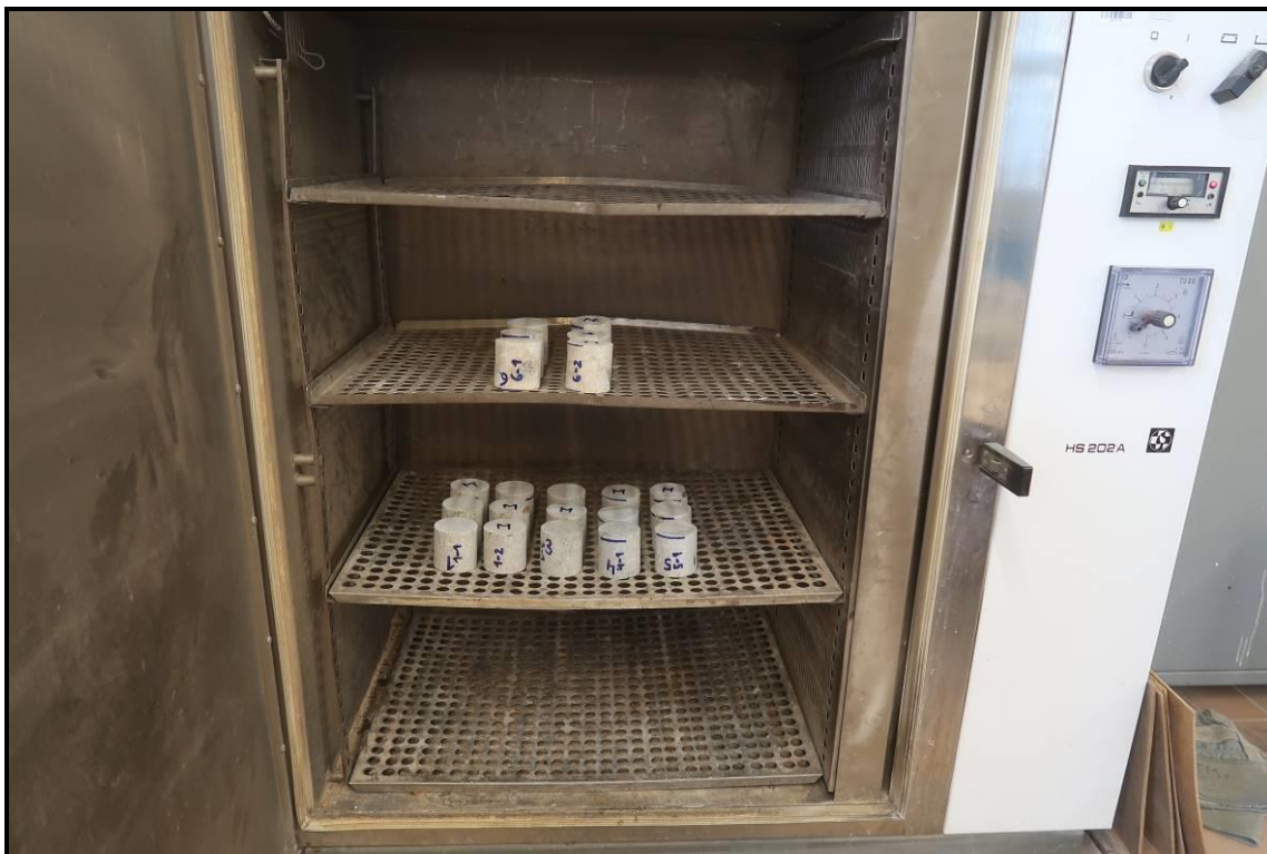
Foto 7: Zkušební tělesa z přírodního kamene v sušárně (sušení do ustálené hmotnosti)
