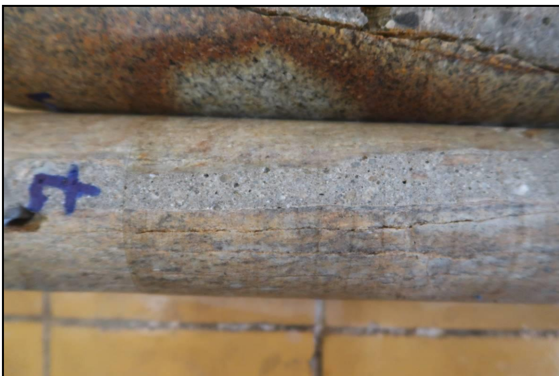
Foto 4: Detail ložné spáry vývrtu V7
