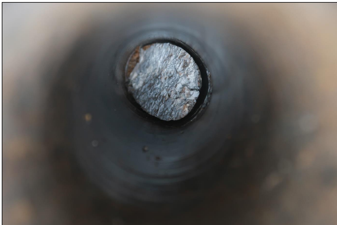
Foto 10: Pohled do výmrtu V3, konec výmrtu odlomen (historicky), patrné jsou výluhy kalcitu na čele
