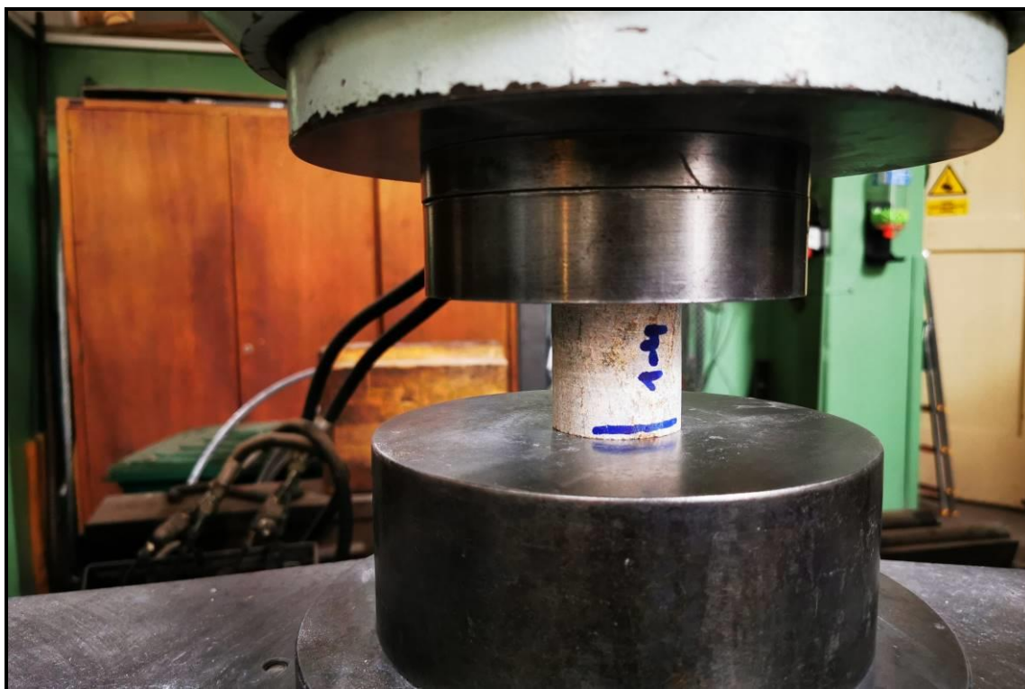
Foto 9: Zkušební těleso 1-4 v zatěžovacím lisu
