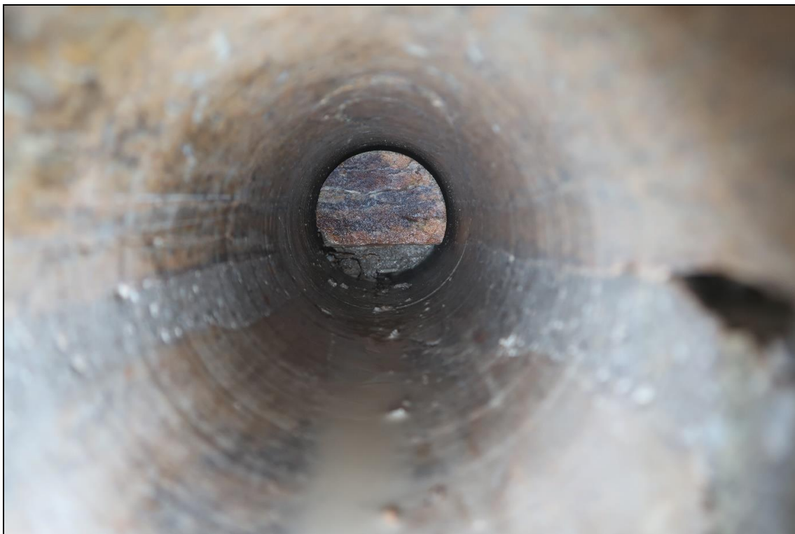
Foto 25: Pohled do vývrtu V7, ložná spára zcela vyplněna betonem/maltou
