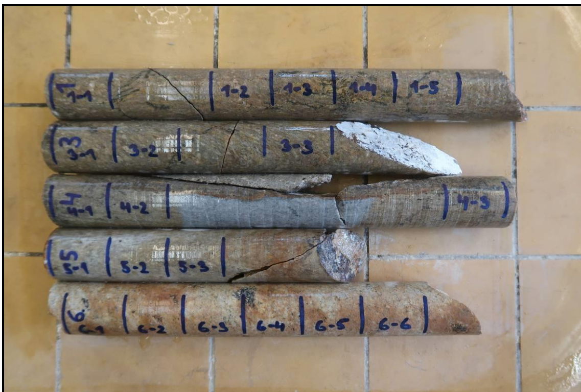
Foto 1: Pohled na vrtná jádra (V1, V3, V4, V5 a V6) Ø 50 mm odebraná z kamenů kleneb vč. označení pro přípravu zkušebních vzorků pro zkoušky v tlaku, vzorky navlhčené vodou
